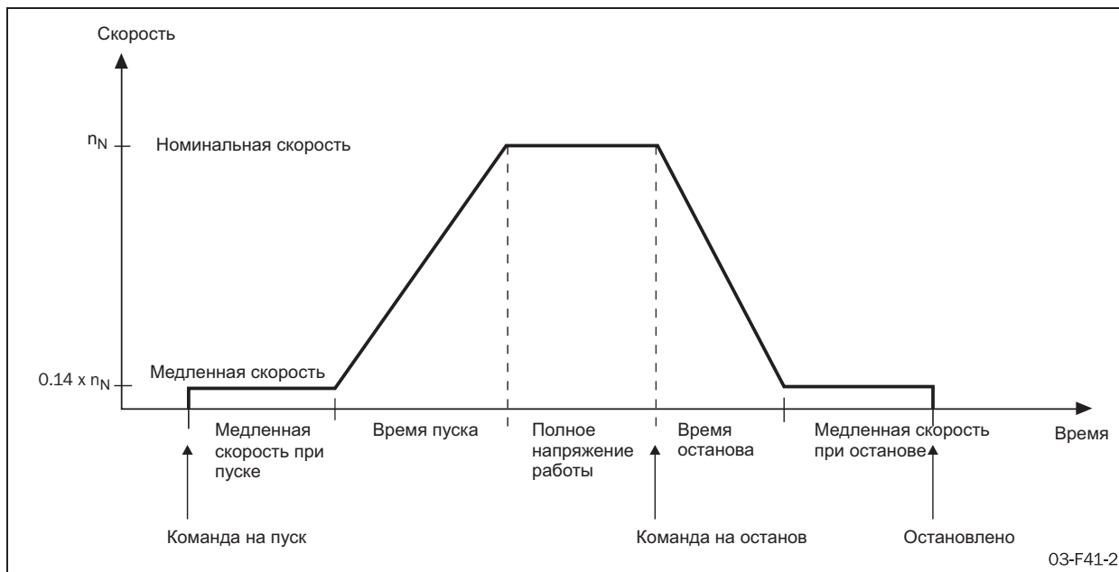
Рис. 46 Медленная скорость при пуске/останове в течение выбранного времени.
