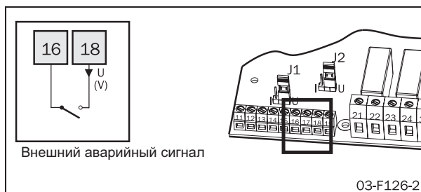
Рис. 65 Соединение клемм для внешнего аварийного сигнала
