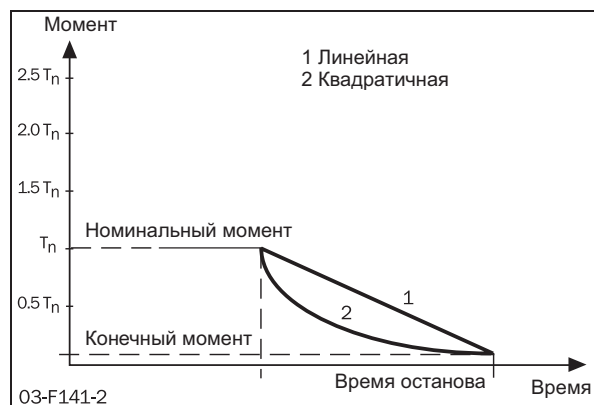
Рис. 42 Контроль момента при останове
